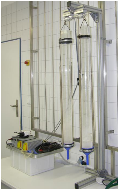
Abbildung 1: Versuchsaufbau zur Bestimmung der Wasserhalbzeit
