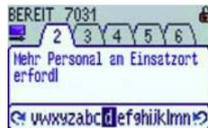
3. Navigationstaste 1x nach oben drücken. Zeichenleiste am unteren Displayrand wird ausgeblendet.
