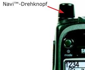
Mit der Modus-Taste schalten Sie Ihr Funkgerät ein bzw. aus.
