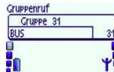
1. PTT-Taste drücken und gedrückt halten. LED am Funkgerät leuchtet rot, ein Signalton ertönt. Im Display erscheint nach Herstellen der Verbindung die Meldung „Sprechen“.
