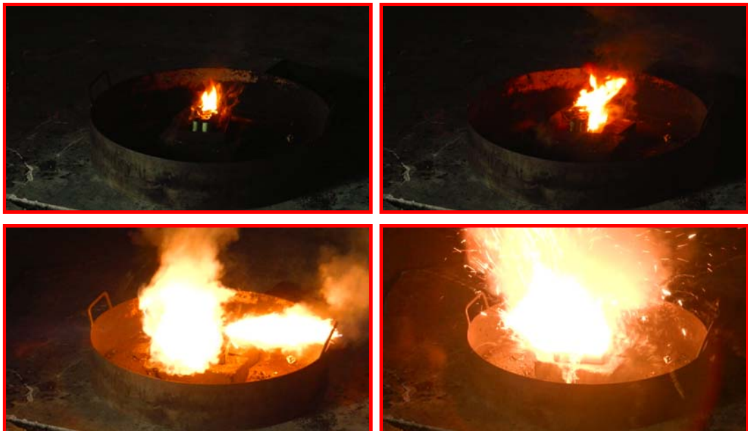
Bild 8: Verschiedene Brandphasen beim Abbrand loser Li-Ionen-Akkus
