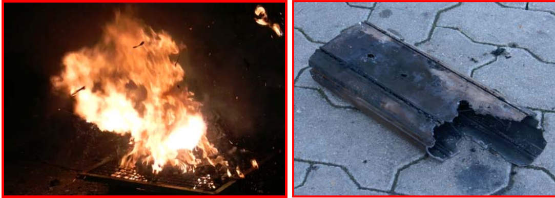
Bild 9: Abbrand eines Akkupacks in OVP Bild 10: Durch Brand zerstörtes Gehäuse
