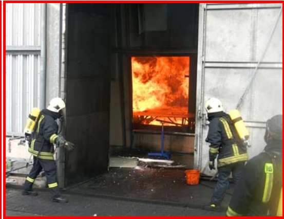
Bild 10: Rückzündung infolge verbliebener Brandmittelmengen
