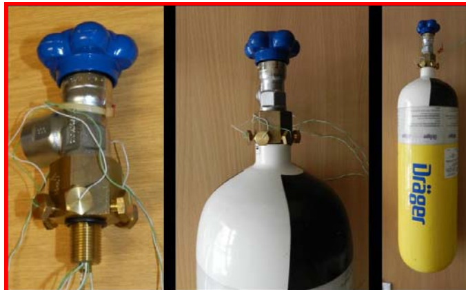
Bild 6: Messadapter zur Messung des Temperaturverlaufs im Inneren der Druckluftflasche
