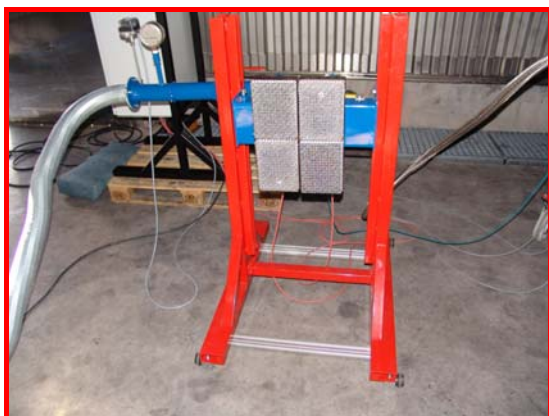
Bild 6: Der mit Propangas betriebene Porenstrahler
