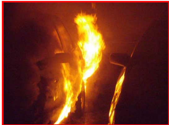
Bild 14: Brandentwicklung vor Anlagenauslösung
