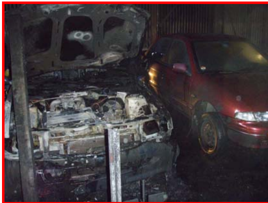
Bild 13: Brandschaden am mittleren Fahrzeug
