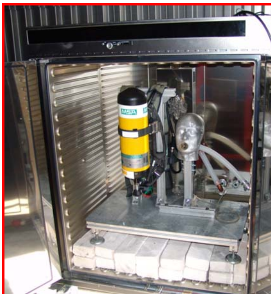
Bild 7: Wärmeschrank mit Versuchsobjekt
