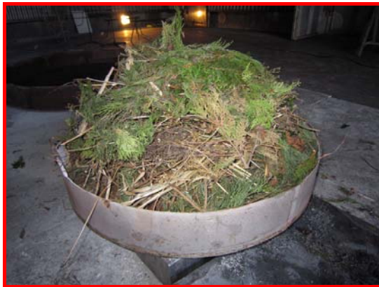
Bild 15: Gartenabfall-Mix für einen Brandversuch
