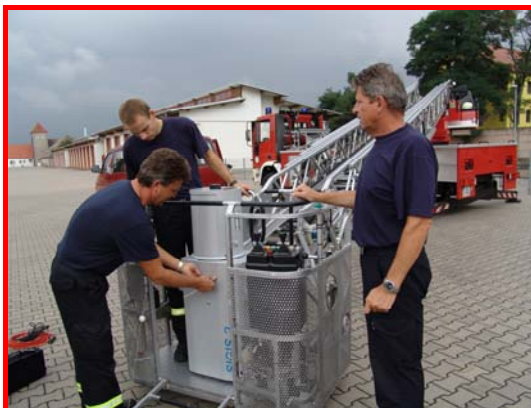
Bild 4 : Das SIGIS wird auf einer Drehleiter montiert
