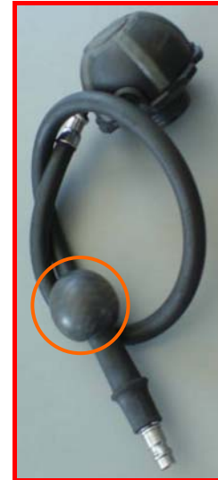
Bild 8: Beschädigung am Schlauch
