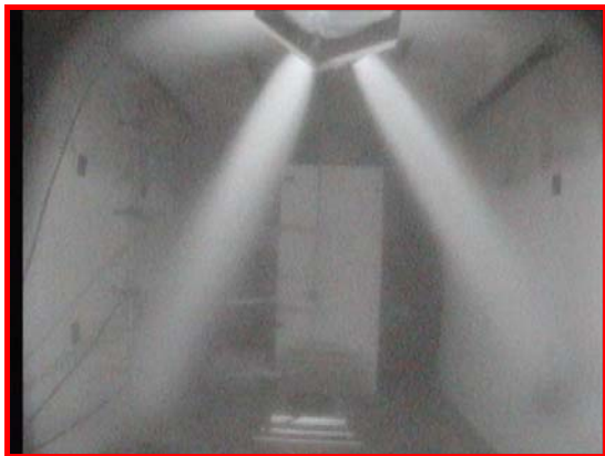
Bild 11: Eindüsen des NOVEC 1230 in den Versuchsraum
