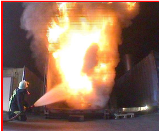
Bild 1 : Versuche zur Schadgasauswaschung Bild 2: Flashover-Versuche im Brandcontainer
