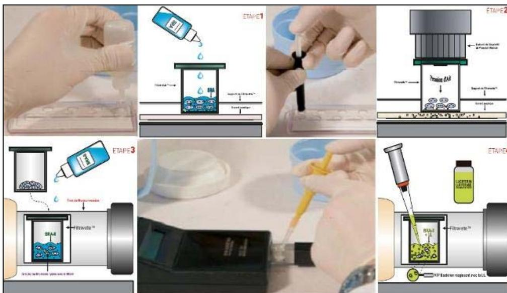
Abb. 27: Wasseruntersuchung auf Bakterien mittels PROFILE-1
