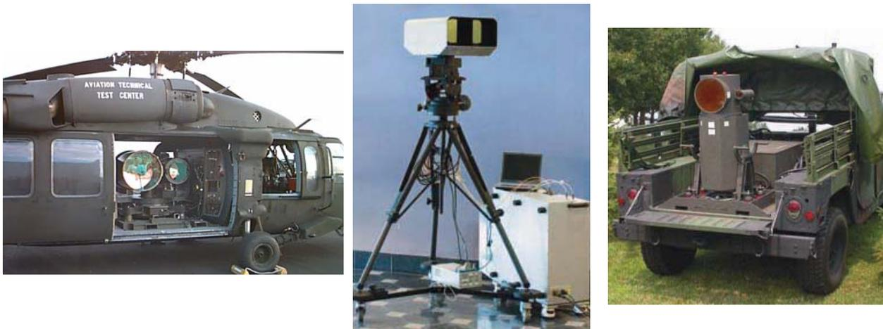
**Abb. 7 - 9: Fernerkundung mit LRBSDS (UV-Laser) und Lidar**
