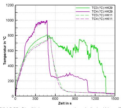
**Bild 5.55:** Oberflächentemperaturen innerhalb der Krippe (TC3, TC4) für Versuche mit Löschdüse C bei 6 bar von der Seite (HK29) und von oben (HK11)
