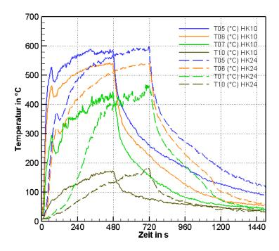
Bild 5.30: Raumtemperaturen in der Ecke für Versuche mit Löschdüse C
