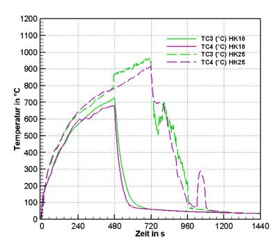
**Bild 5.22:** Oberflächentemperaturen innerhalb der Krippe (TC3, TC4) für Löschversuche mit Düse B bei 3 bar nach 8 min (HK18) und 12 min (HK25)
