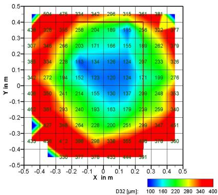
**Bild 4.17:** Tropfengrößenverteilung (Sauterdurchmesser) auf der Messfläche bei 1 bar (oben) und 3 bar (unten) mit Löschdüse B
