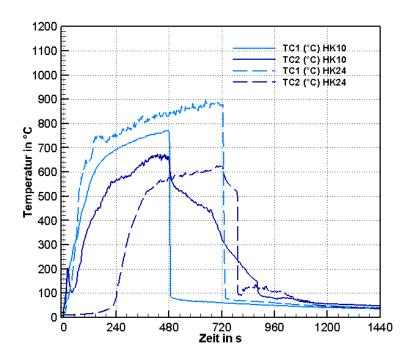
**Bild 5.31:** Oberflächentemperaturen innerhalb der Krippe (TC3, TC4) für Löschversuche mit Düse C bei 5 bar nach 8 min (HK10) und 12 min (HK24)
