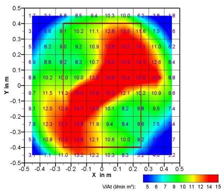
**Bild 4.4:** Grafische Darstellung der ermittelten Volumenstromdichte für Düse B bei 2 bar (oben) und 3 bar (unten)
