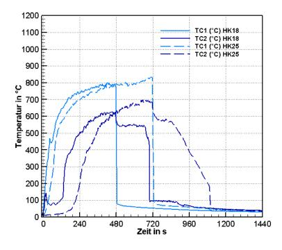
**Bild 5.21:** Krippentemperatur (TC1 und TC2) für die Löschversuche mit Düse B bei 3 bar nach 8 min (HK18) und 12 min (HK25)
