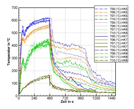
Bild 5.2: Raumtemperaturen in der Ecke für Versuche mit Löschdüse A
