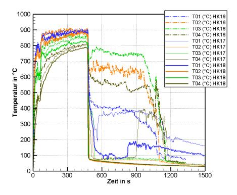
Bild 5.14: Temperaturen über der Brandquelle für Versuche mit Löschdüse B
