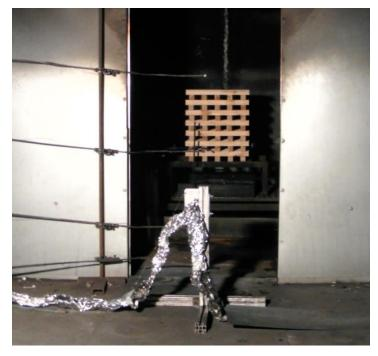
Bild 3.9: Position des wassergekühlten Wärmestromsensors
