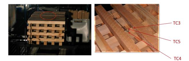
**Bild 3.7:** Anordnung der Thermoelemente TC3, TC4, TC5 im Innern der Krippe - links: Holzkrippe mit 8 Lagen; rechts: Position der Thermoelemente in der Krippe
