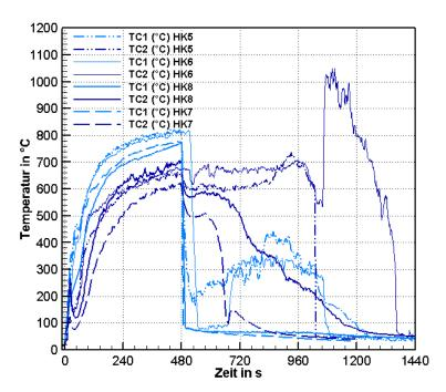
**Bild 5.4:** Temperaturen an der Oberfläche der Krippe (TC1, TC2) für Versuche mit Löschdüse A
