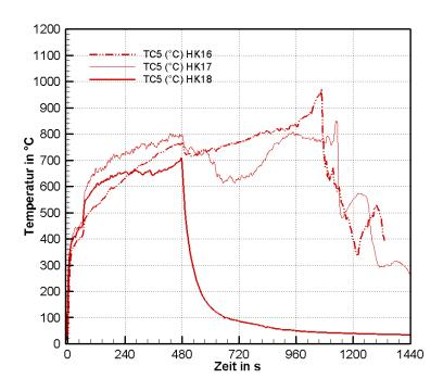
Bild 5.18: Gastemperatur innerhalb der Krippe (TC5) für Versuche mit Löschdüse B
