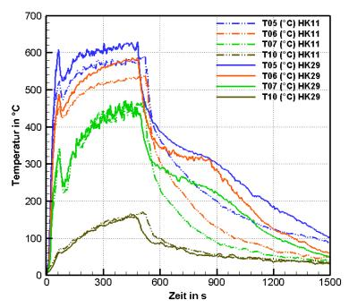
**Bild 5.53:** Raumtemperaturen in der Ecke für Versuche mit Wasserbeaufschlagung mit Löschdüse C bei 6 bar von der Seite (HK29) und von oben (HK11)
