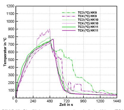
**Bild 5.27:** Oberflächentemperaturen innerhalb der Krippe (TC3, TC4) für Versuche mit Löschdüse C
