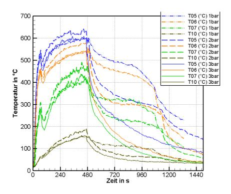
Bild 5.15: Raumtemperaturen in der Ecke für Versuche mit Löschdüse B
