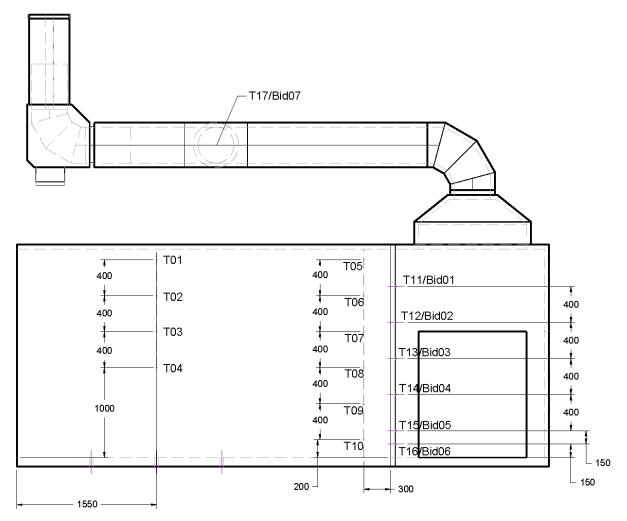
**Bild 3.4:** Seitenansicht des Brandcontainers mit Anordnung der Temperatur- und Geschwindigkeitsmessstellen
