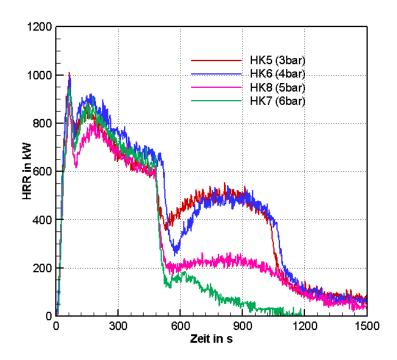
**Bild 5.7:** Vergleich der HRR für Versuche HK5 (3 bar), HK6 (4 bar), HK7 (6 bar) und HK8 (5 bar) mit Löschdüse A
