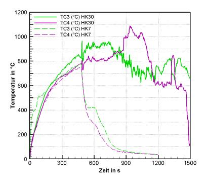
**Bild 5.45:** Oberflächentemperaturen innerhalb der Krippe (TC3, TC4) für Versuche mit Löschdüse A bei 6 bar von der Seite (HK30) und von oben (HK7)
