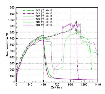
**Bild 5.17:** Oberflächentemperaturen innerhalb der Krippe (TC3, TC4) für Versuche mit Löschdüse B
