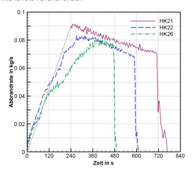
Bild 5.35: Abbrandrate der Versuche mit Holzkrippen von 0,8 m x 0,8 m Grundfläche
