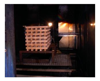
Bild 5.41: Krippenanordnung in Versuch HK27 bei seitlicher Löschwasserbeaufschlagung
