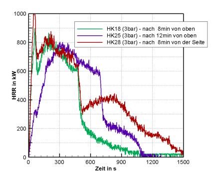
**Bild 5.52:** Vergleich der HRR für Versuche mit Löschdüse B bei 3 bar von der Seite (HK28) und von oben (HK18, HK25)
