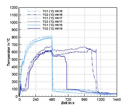
**Bild 5.16:** Temperaturen an der Krippenoberfläche (TC1, TC2) für Versuche mit Löschdüse B
