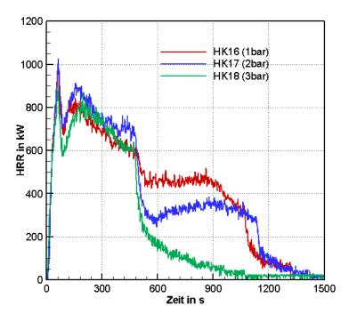
**Bild 5.19:** Vergleich der HRR für Versuche HK16 (1 bar), HK17 (2 bar), HK18 (3 bar) mit Löschdüse B
