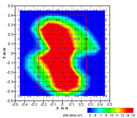
**Bild 4.5:** Grafische Darstellung der ermittelten Volumenstromdichte für Düse C bei 4 bar (oben) und 6 bar (unten)
