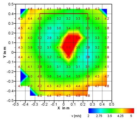
**Bild 4.16:** Tropfengeschwindigkeitsverteilung auf der Messfläche bei 1 bar (oben) und 3 bar (unten) mit Löschdüse B
