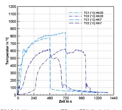
**Bild 5.10:** Krippentemperatur (TC1 und TC2) für die Löschversuche mit Düse A bei 6 bar nach 8 min (HK7) und 12 min (HK23)
