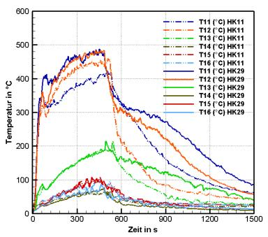
**Bild 5.54:** Temperaturen in der Durchgangstür für Versuche mit Löschdüse C bei 6 bar von der Seite (HK29) und von oben (HK11)
