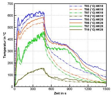
**Bild 5.47:** Raumtemperaturen in der Ecke für Versuche mit Wasserbeaufschlagung mit Löschdüse B bei 3 bar von der Seite (HK28) und von oben (HK18)
