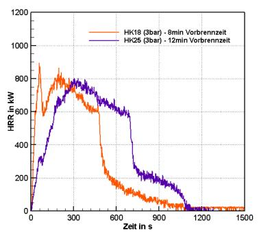
Bild 5.24: Vergleich der HRR für Versuche HK18 und HK25 mit Löschdüse B und 3 bar
