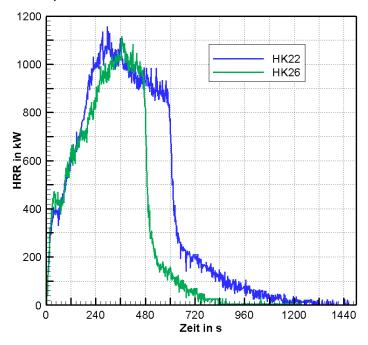
Bild 5.36: Ermittelte HRR für Versuche mit größeren Holzkrippen (HK22 und HK26)
