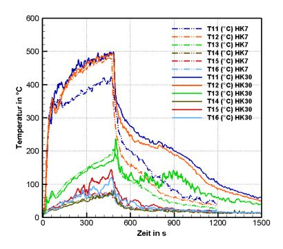
**Bild 5.43:** Temperaturen in der Durchgangstür für Versuche mit Löschdüse A bei 6 bar von der Seite (HK30) und von oben (HK7)
