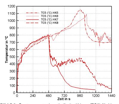
Bild 5.6: Gastemperatur innerhalb der Krippe (TC5) für Versuche mit Löschdüse A
