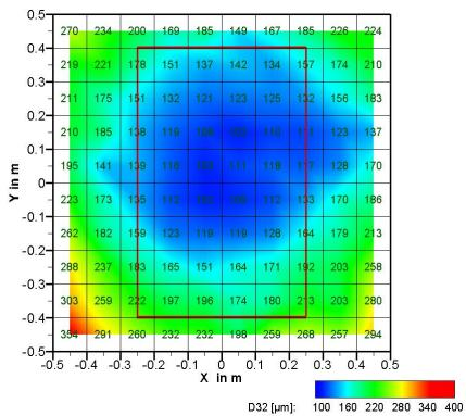
**Bild 4.15:** Tropfengrößenverteilung (Sauterdurchmesser) auf der Messfläche bei 4 bar (oben) und 6 bar (unten) mit Löschdüse A
