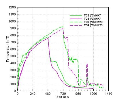
**Bild 5.11:** Oberflächentemperaturen innerhalb der Krippe (TC3, TC4) für Löschversuche mit Düse A bei 6 bar nach 8 min (HK7) und 12 min (HK23)
