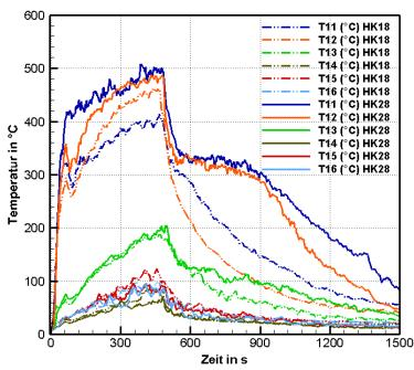
**Bild 5.48:** Temperaturen in der Durchgangstür für Versuche mit Löschdüse B bei 3 bar von der Seite (HK28) und von oben (HK18)
