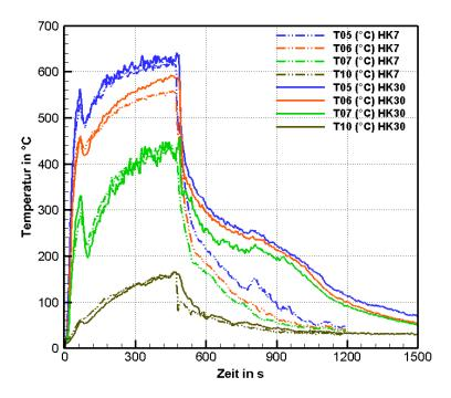
**Bild 5.42:** Raumtemperaturen in der Ecke für Versuche mit Wasserbeaufschlagung mit Löschdüse A bei 6 bar von der Seite (HK30) und von oben (HK7)
