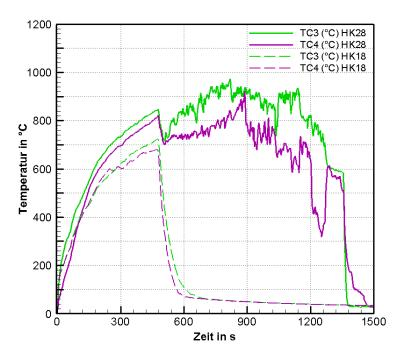
**Bild 5.50:** Oberflächentemperaturen innerhalb der Krippe (TC3, TC4) für Versuche mit Löschdüse A bei 6 bar von der Seite (HK28) und von oben (HK18)
