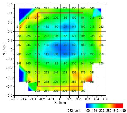
**Bild 4.19:** Tropfengrößenverteilung (Sauterdurchmesser) auf der Messfläche bei 4 bar (oben) und 5 bar (unten) mit Löschdüse C
