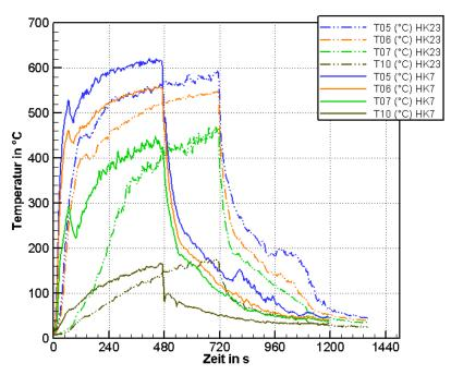
**Bild 5.9:** Vergleich der Raumtemperaturen (in der Ecke) für die Löschversuche mit Düse A bei 6 bar nach 8 min (HK7) und 12 min (HK23)
