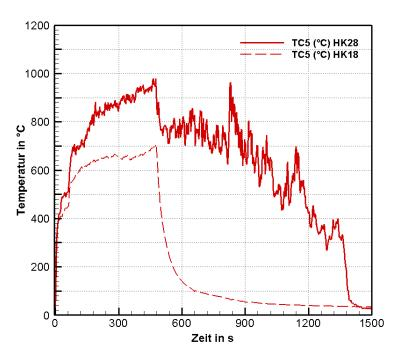
**Bild 5.51:** Gastemperatur innerhalb der Krippe (TC5) für Versuche mit Löschdüse B bei 3 bar von der Seite (HK28) und von oben (HK18)
