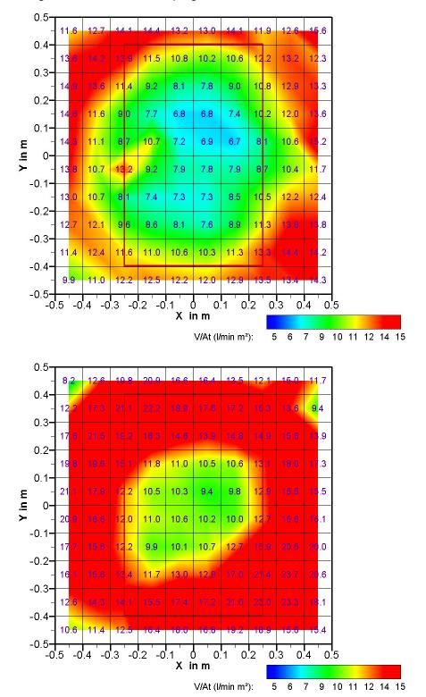
**Bild 4.3:** Grafische Darstellung der ermittelten Volumenstromdichte für Düse A bei 5 bar (oben) und 6 bar (unten)
