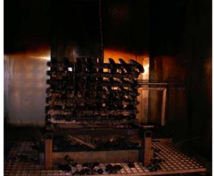
Restmasse-Holzkrippe aus Sicht der Containertür nach dem Versuch HK28
