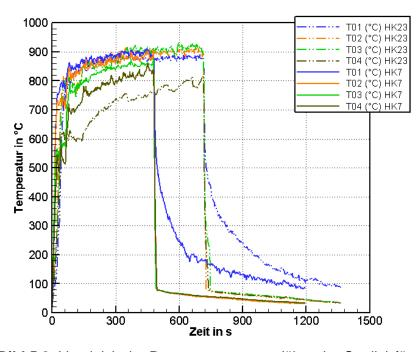
**Bild 5.8:** Vergleich der Raumtemperaturen (über der Quelle) für die Löschversuche mit Düse A bei 6 bar nach 8 min (HK7) und 12 min (HK23)
