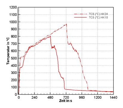
**Bild 5.32:** Gastemperatur in der Krippe (TC5) für die Löschversuche mit Düse C bei 5 bar nach 8 min (HK10) und 12 min (HK24)
