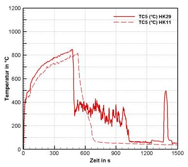
**Bild 5.56:** Gastemperatur innerhalb der Krippe (TC5) für Versuche mit Löschdüse C bei 6 bar von der Seite (HK29) und von oben (HK11)
