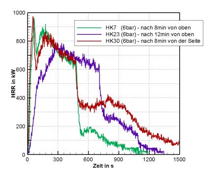
**Bild 5.46:** Vergleich der HRR für Versuche mit Löschdüse A und 6 bar von der Seite (HK30) und von oben (HK7, HK23)
