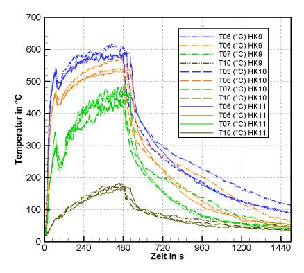
Bild 5.25: Raumtemperaturen in der Ecke für Versuche mit Löschdüse C
