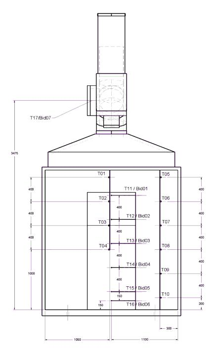
**Bild 3.5:** Vorderansicht des Brandcontainers mit Anordnung der Temperatur- und Geschwindigkeitsmessstellen
