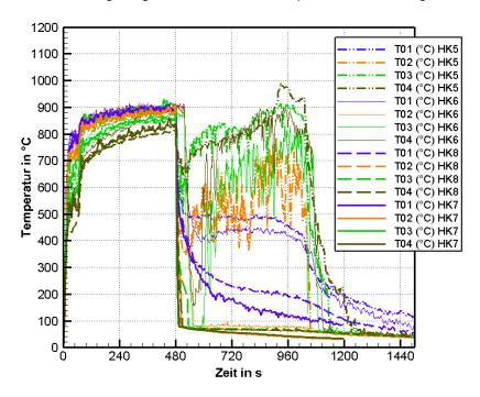
Bild 5.1: Temperaturen über der Brandquelle für Versuche mit Löschdüse A
