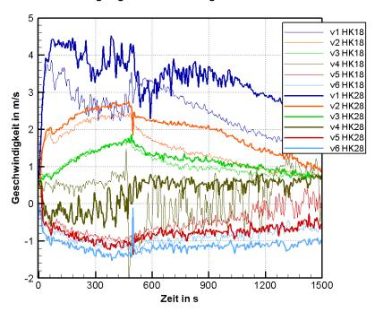
**Bild 5.49:** Geschwindigkeiten in der Durchgangstür für Versuche mit Löschdüse B bei 3 bar von der Seite (HK28) und von oben (HK18)
