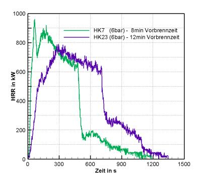
Bild 5.13: Vergleich der HRR für Versuche HK7 und HK23 mit Löschdüse A und 6 bar
