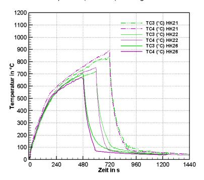
**Bild 5.38:** Oberflächentemperaturen (TC3, TC4) im Innern der Krippe in den Versuchen HK21, HK22 und HK26
