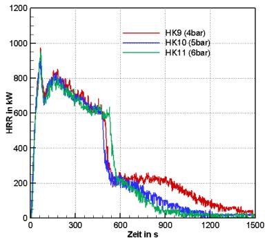
**Bild 5.29:** Vergleich der HRR für Versuche HK9 (4 bar), HK10 (5 bar), HK12 (6 bar) mit Löschdüse C
