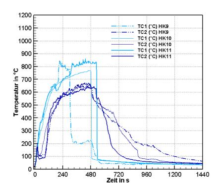
**Bild 5.26:** Temperaturen an der Krippenoberfläche (TC1, TC2) für Versuche mit Löschdüse C
