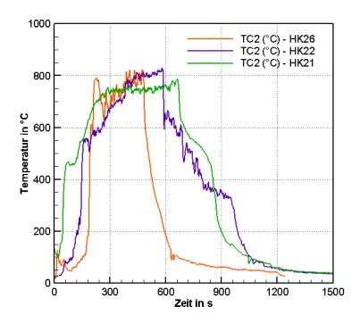
**Bild 5.40:** Temperaturen an der Oberfläche der Krippe (TC2) in den Versuchen HK21, HK22 und HK26
