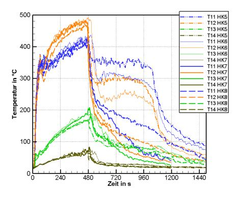
Bild 5.3: Temperaturen in der Durchgangstür für Versuche mit Löschdüse A
