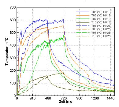
**Bild 5.20:** Vergleich der Raumtemperaturen (in der Ecke) für die Löschversuche mit Düse B bei 3 bar nach 8 min (HK18) und 12 min (HK25)
