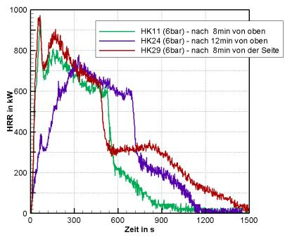
**Bild 5.57:** Vergleich der HRR für Versuche mit Löschdüse C bei 6 bar von der Seite (HK29) und von oben (HK11, HK24)
