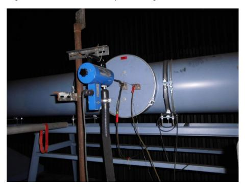
**Bild 3.6:** Beheizte Probenahmesonde für die FTIR-Messung am Messstutzen des Abgasrohres
