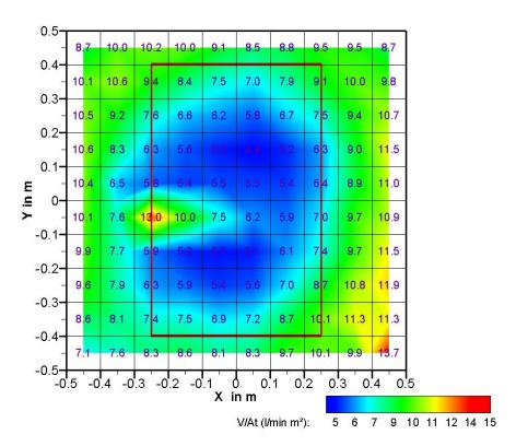
Bild 4.2: Grafische Darstellung der ermittelten Volumenstromdichte für Düse A bei 4 bar
