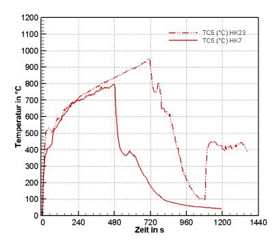
**Bild 5.12:** Gastemperatur in der Krippe (TC5) für die Löschversuche mit Düse A bei 6 bar nach 8 min (HK7) und 12 min (HK23)
