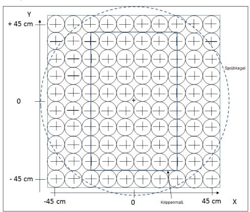
Bild 4.13: Messraster der PDA-Messung (Draufsicht)
