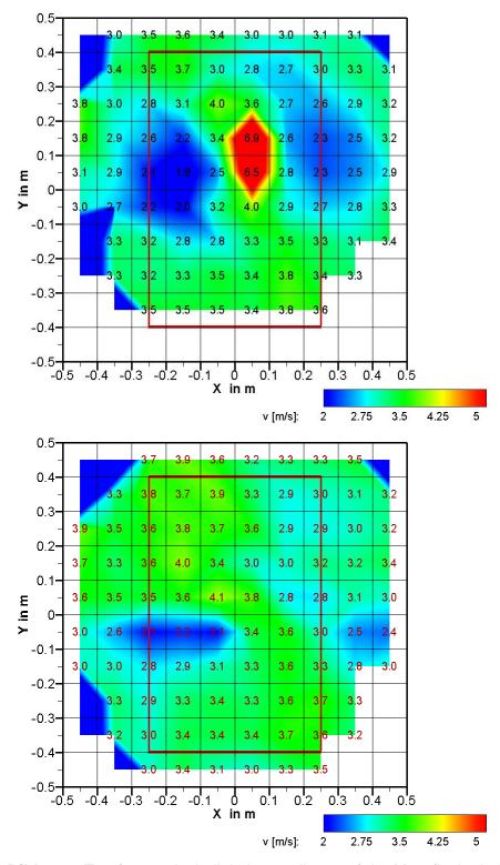
**Bild 4.18:** Tropfengeschwindigkeitsverteilung auf der Messfläche bei 4 bar (oben) und 5 bar (unten) mit Löschdüse C
