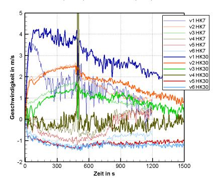
**Bild 5.44:** Geschwindigkeiten in der Durchgangstür für Versuche mit Löschdüse A bei 6 bar von der Seite (HK30) und von oben (HK7)
