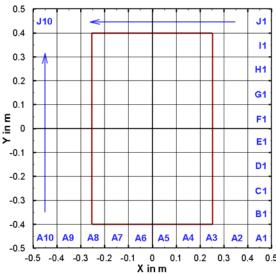
**Bild 4.1:** Anordnung der Messgefäße auf der Messfläche von 1 m² Größe auf dem PDA-Messplatz
