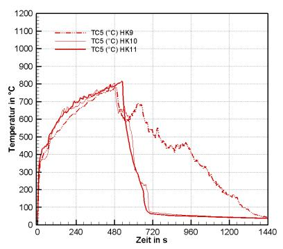
Bild 5.28: Gastemperatur in der Krippe (TC5) für Versuche mit Löschdüse C nach 8 min
