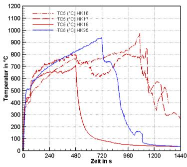
**Bild 5.23:** Gastemperatur in der Krippe (TC5) für die Löschversuche mit Düse B bei 3 bar nach 8 min (HK18) und 12 min (HK25)
