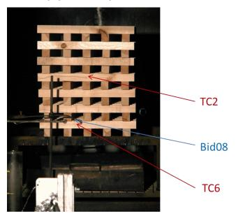
**Bild 3.8:** Lage der Messstelle TC2 für die Oberflächentemperatur sowie Messstellen TC6 und Bid08 für die Gasgeschwindigkeit
