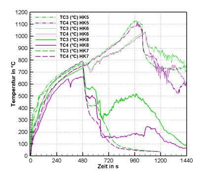
**Bild 5.5:** Oberflächentemperaturen innerhalb der Krippe (TC3, TC4) für Versuche mit Löschdüse A
