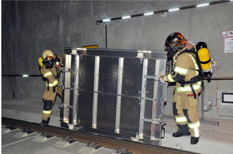
**Bild C5.4:** Aufsetzen der Rollpalette auf die Schienen [Innsbruck 2012]
