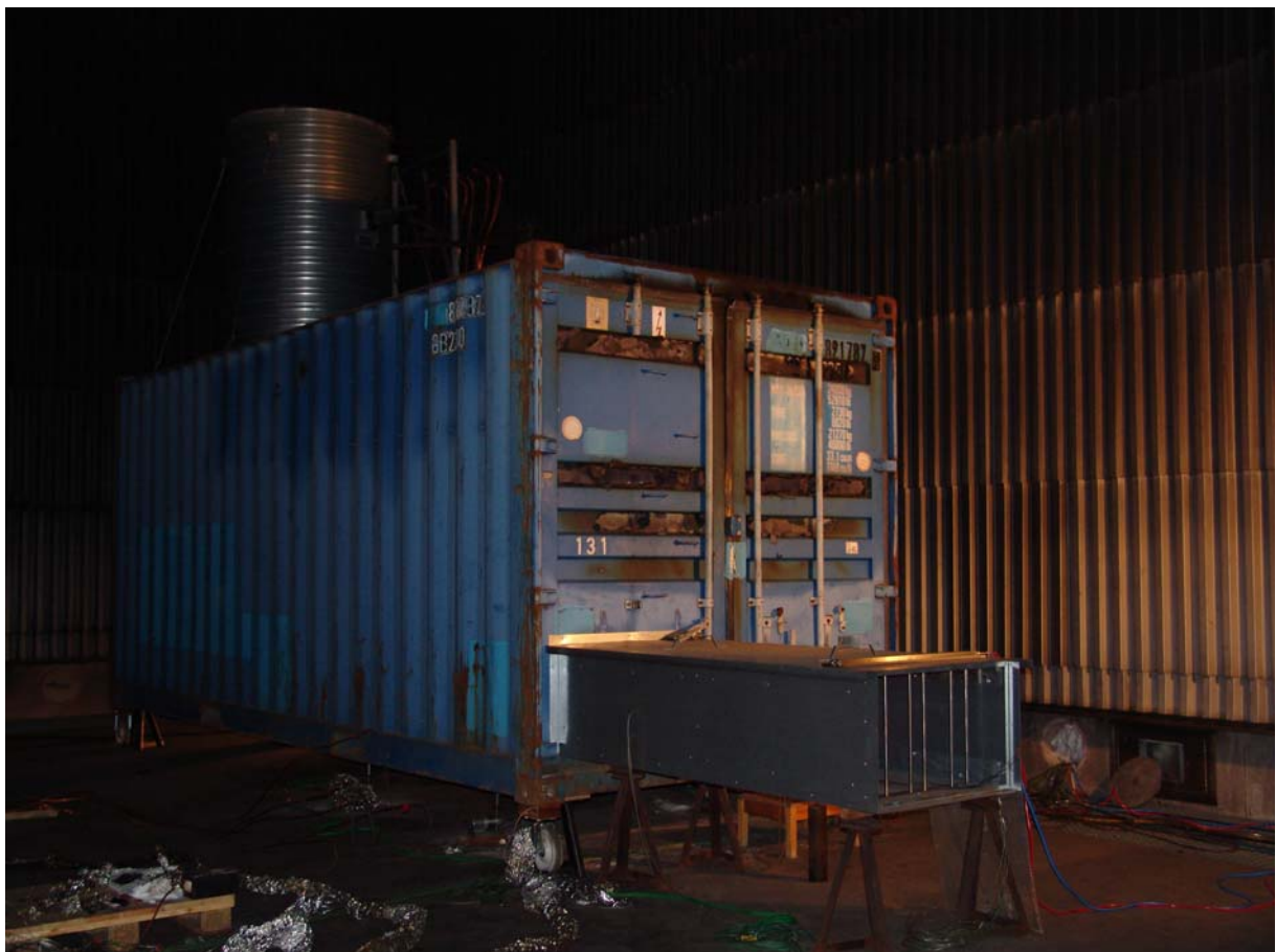
Abb. 13: Versuchseinrichtung im Bulk-Container mit Zuluftscht und Abgasschlot
