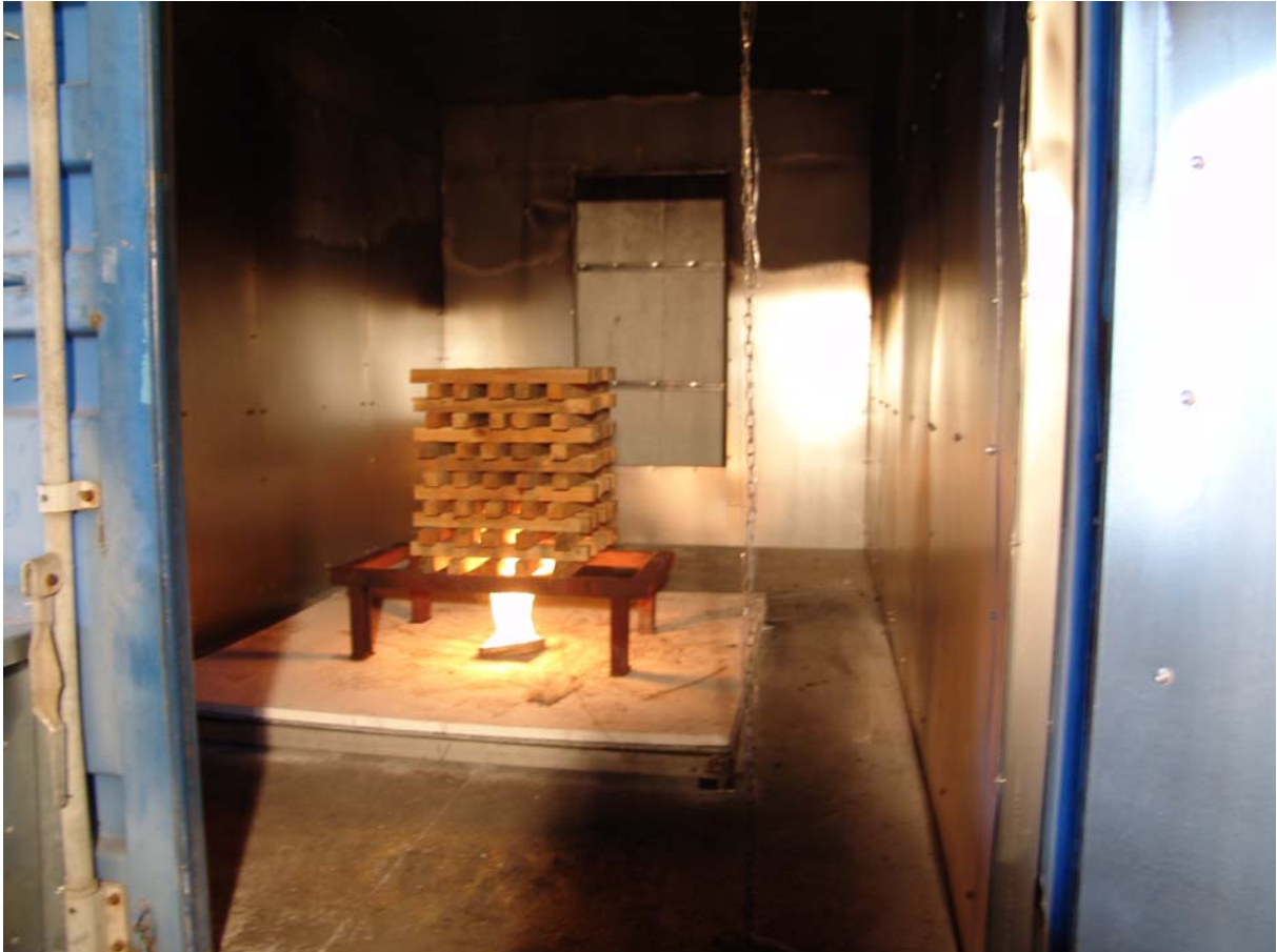
Abb. 14: Innenansicht der Versuchseinrichtung kurz nach Zündung der Holzkrippen
