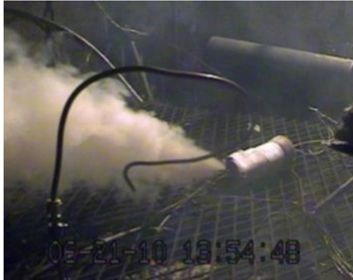
Abbildung 3: Austritt von Gasen/ Dämpfen während des TR einer zylindrischen Zelle [18]
