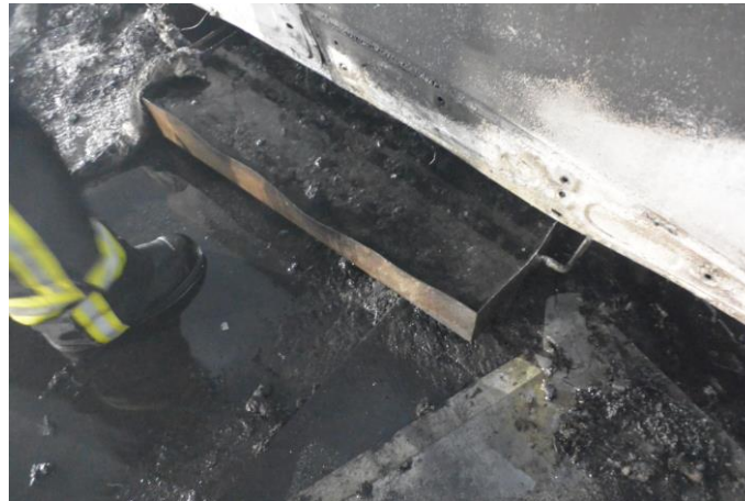
Abbildung 23: Auffangwanne mit Brandrückständen und Löschwasser
