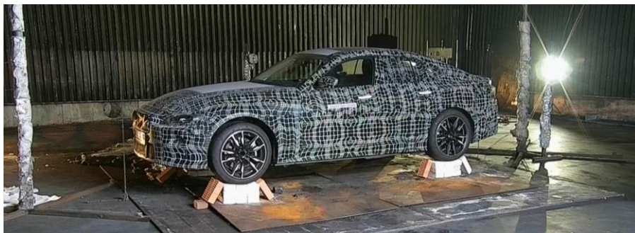
Abbildung 11: BMW i4 im Brandraum des IBK
