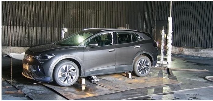
Abbildung 15: Volkswagen ID.4 im Brandraum des IBK
