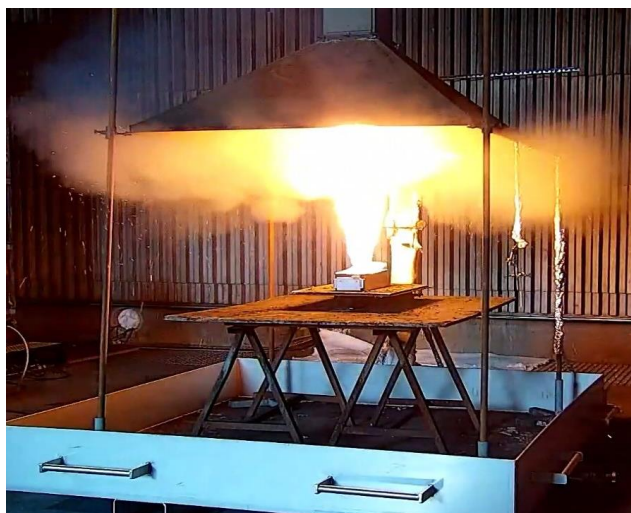
Abbildung 4: Austritt von Stichflammen nach Penetration einer prismatischen Zelle (SoC > 90 %) eines Batteriemoduls mit einer Nagelpistole
