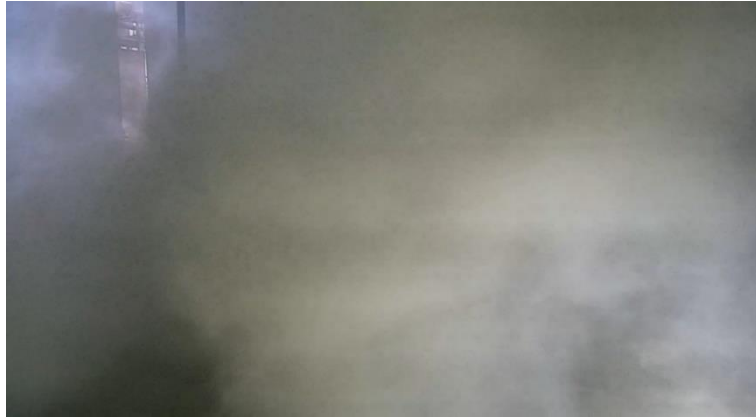
Abbildung 6: Austritt großer Mengen zum Teil brennbarer Gase/ Dämpfe/ Zersetzungsprodukte nach Penetration eines im BEV eingebauten Batteriesystems
