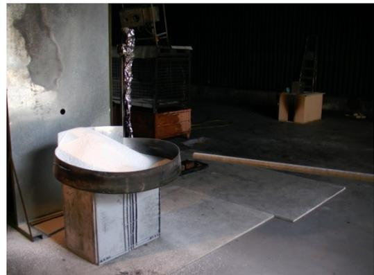
**Bild 3.4:** Ausblasversuch mit fester Einspannung eines langen Düsenrohres (vor Brandversuch 001)
