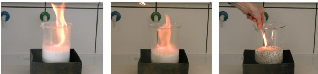
**Bild 2.17:** Fotos der Zündtests bei Mikro-Glashohlkugeln, PyroBubbles und NEBUFIGHT Granulat (v.l.n.r.)
