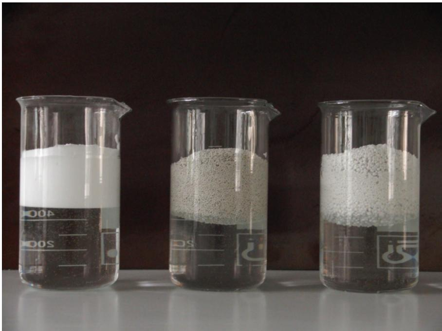
**Bild 1.1:** Feststofflöschmittel in Granulatform (Glashohlkugeln, NEBU®FIGHT Granulat, PyroBubbles® v. l. n. r.)
