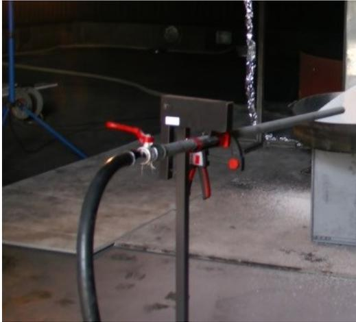
**Bild 3.3:** Versuchsanordnung mit fester Einspannung und Verlängerung des Düsenrohres
