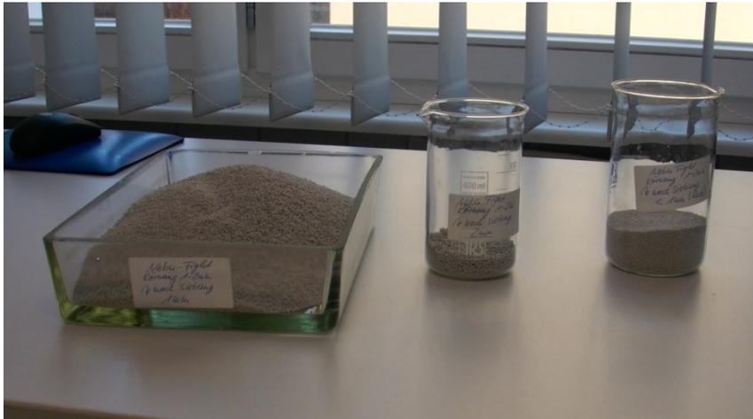
**Bild 2.10:** NEBUFIGHT der Körnung 1-2 mm nach Siebanalyse
