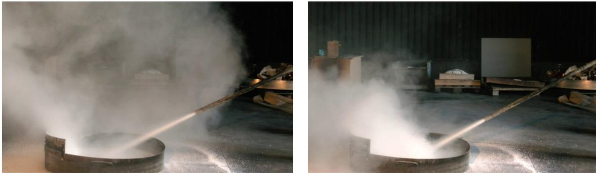
**Bild 3.6:** Momentaufnahmen des Ausbringversuchs mit PyroBubbles nach 10 s (links) und nach 40 s (rechts)
