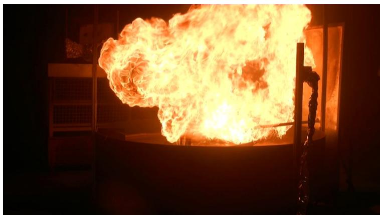
**Bild 3.13:** Videoschnappschuss des Flammenbrandes mit Beginn der Löschmittelfreigabe (Druckstoß) im Versuch 004
