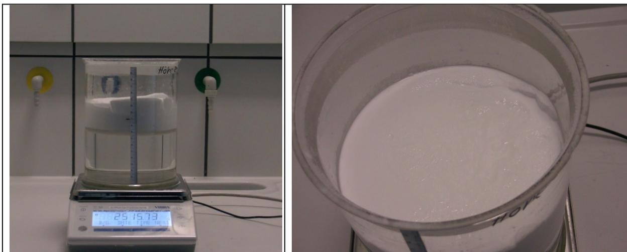
**Bild 2.15:** Verdunstungsversuch mit Mikro-Glashohlkugeln (links: Messwertfassung, rechts: Oberfläche)
