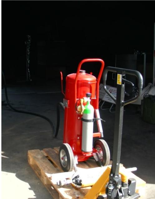
**Bild 3.1:** Einsatzbereiter PyroBubblelöscher für einen Ausblasversuch
