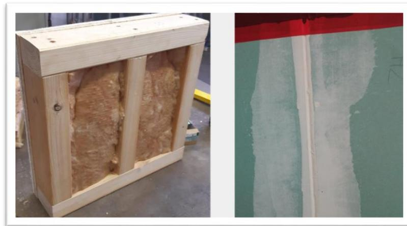
**Abbildung 7: links: Holztafelbauprobekörper von hinterer Seite beplankt, Hohlräume mit Mineralwolle verfüllt; rechts: verspachtelter Stoß der Gipskartonschicht an der Holztafelwand**
