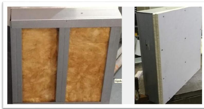
**Abbildung 5: Gipskarton-Probekörper links: unbeplankt; rechts: beplankt**
