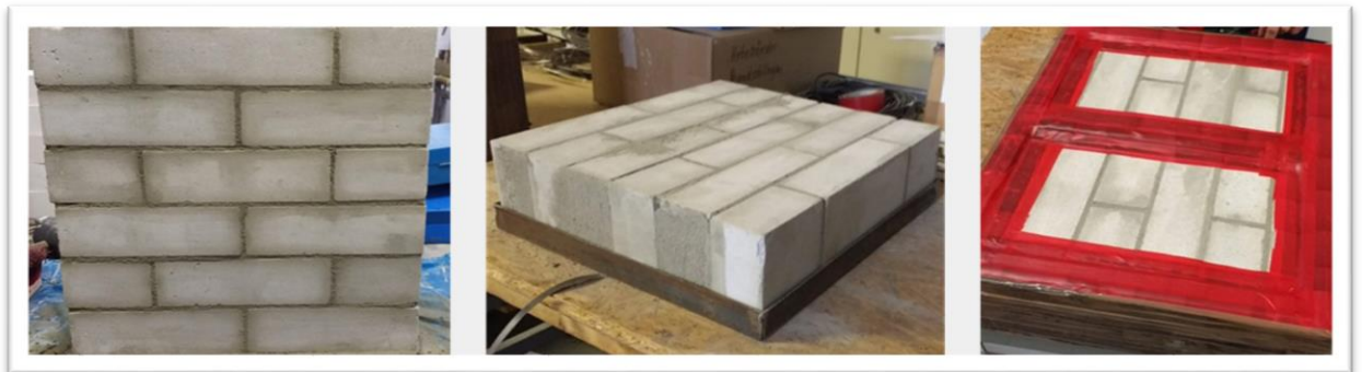
Abbildung 8: links: Probekörper aus gemauerten Kalksandsteinen; Mitte: mit stabilisierendem Stahlrahmen; rechts: mit Isolierung
