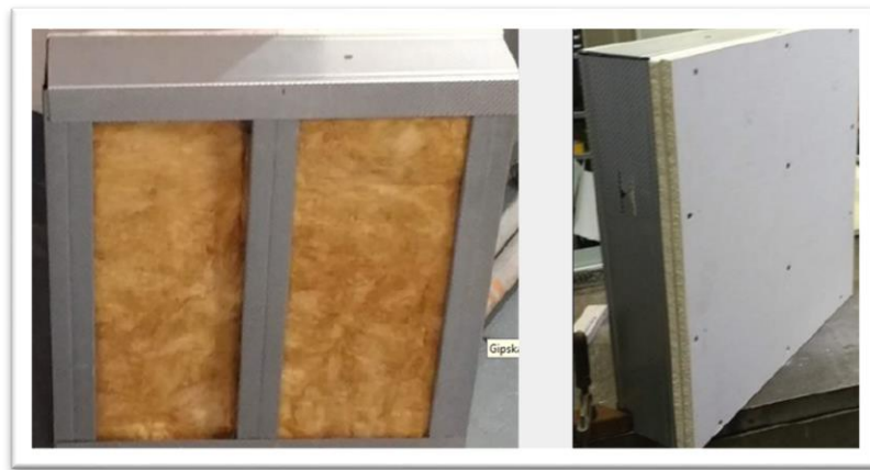
Abbildung 5: Gipskarton-Probekörper links: unbeplankt; rechts: beplankt
