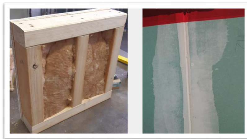
Abbildung 7: links: Holztafelbauprobekörper von hinterer Seite beplankt, Hohlräume mit Mineralwolle verfüllt; rechts: verspachtelter Stoß der Gipskartonschicht an der Holztafelwand
