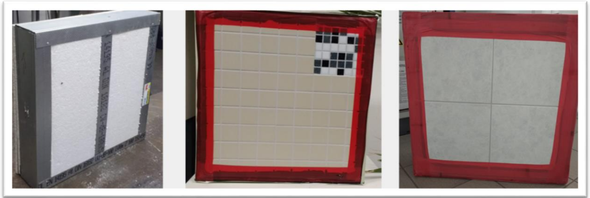
Abbildung 6: links: Probekörper Gipskartoneinfachständerwand mit Polystyrol­dämmung, einseitig noch unbeplankt; mittig: Probekörper Gipskartoneinfachständerwand mit einseitiger Fliesenoberfläche (klein), rechts: Probekörper Gipskartoneinfachständerwand mit einseitiger Fliesenoberfläche (groß).
