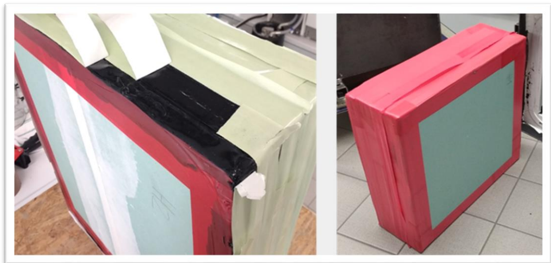
Abbildung 13: links: schwarzes, beidseitig klebendes Butylkautschukband auf den Seitenflächen des Probekörpers; rechts: Abklebung mit rotem, gasdichtem Klebeband (final isolierter Wandprobekörper)
