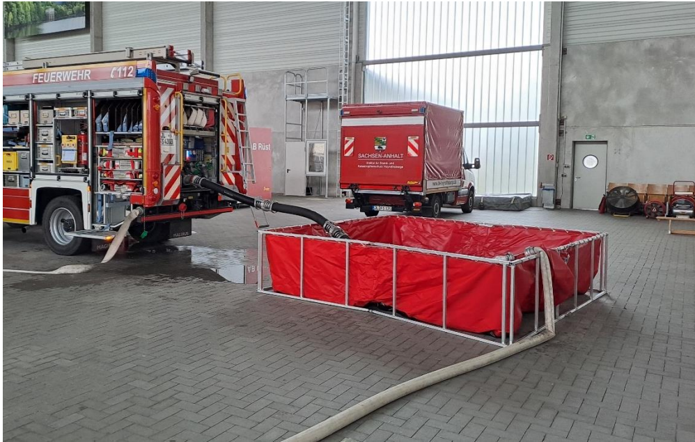
Abbildung 56: Löschangriff mit aufgebautem mobilen Löschwasserbehälter
