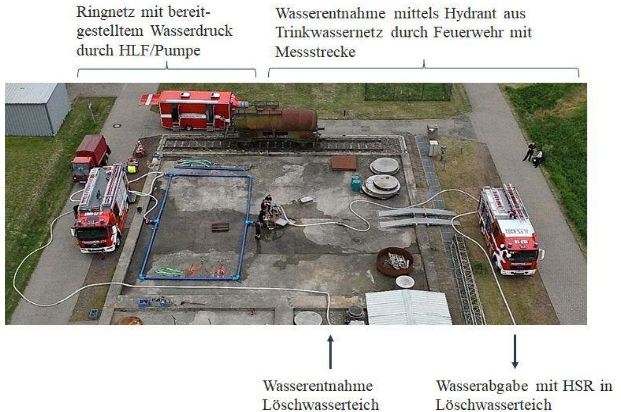
Abbildung 25: Messaufbau bestehend aus Ringnetz und aufgebautem Löschangriff
