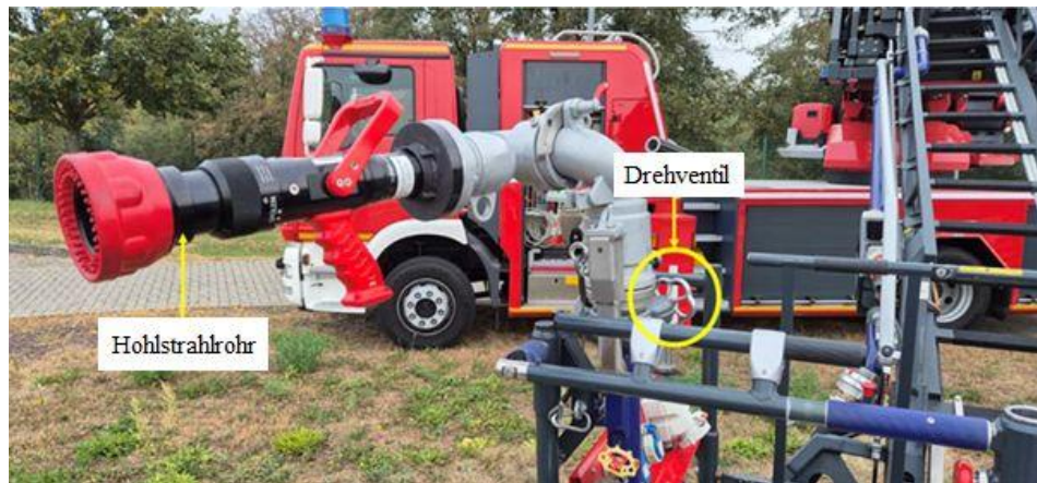
Abbildung 46: Montiertes Strahlrohr an der Leitung des Drehleiterkorbs
