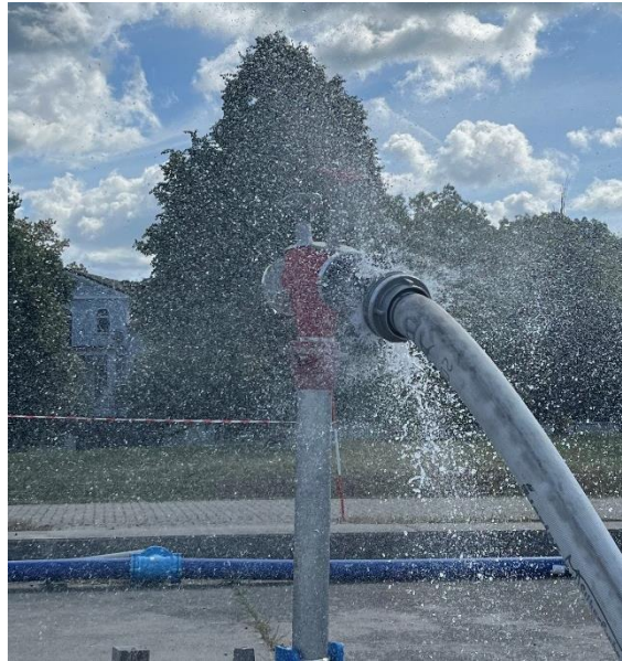
Abbildung 3: auslösender Systemtrenner B-FW nach DIN 14346
