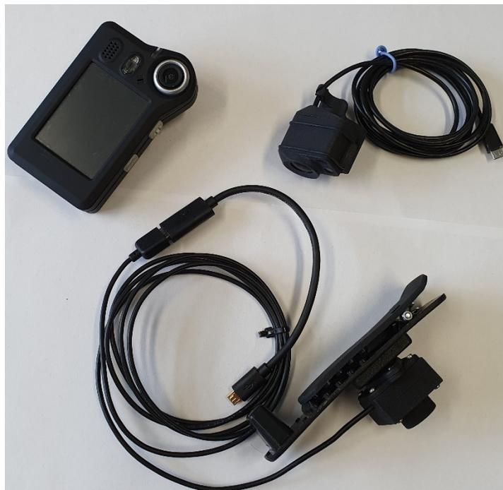
Abbildung 11: NetCo Body-Cam und zwei Modelle der ThirdEye-Cam
