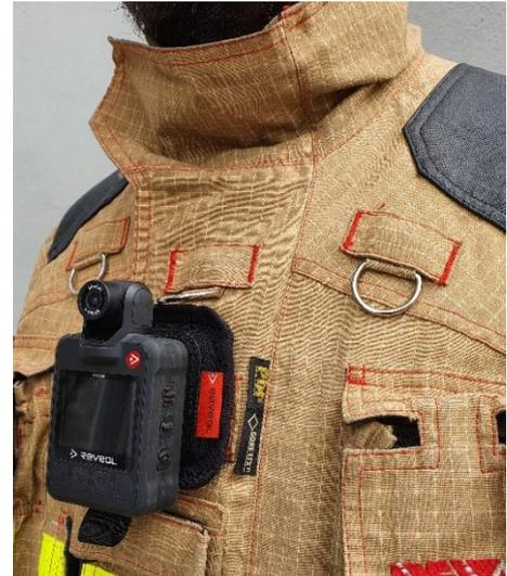
Abbildung 20: Reveal D5 befestigt mit Magnetplatten an der Reißverschlussüberdeckung in Brustmitte
