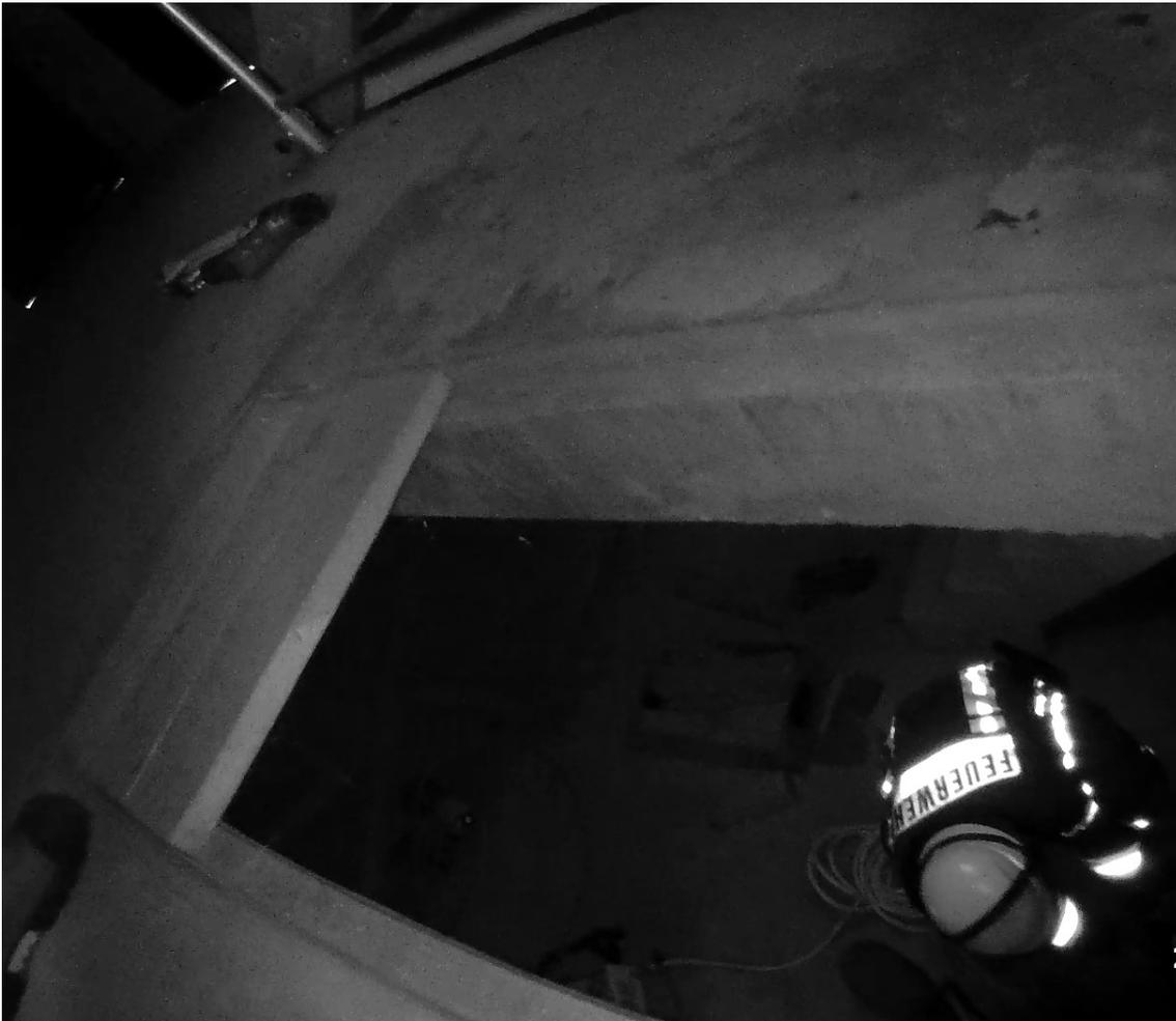
Abbildung 13: Infrarotbild der Zepcam T2 in einem Kellerraum bei sehr schwachem Umgebungslicht
