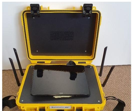
Abbildung 7: Basisstation mit vier externen Antennen und Tablet.
