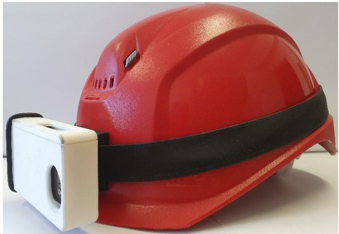
Abbildung 14: Montage der BOS Cam Individual mit Band am Kletterhelm
