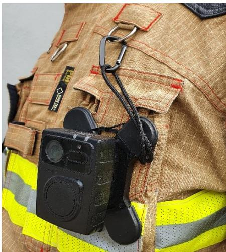
Abbildung 21: Zepcam T2 befestigt mit Magnetplatte und Karabiner an Brusttasche
