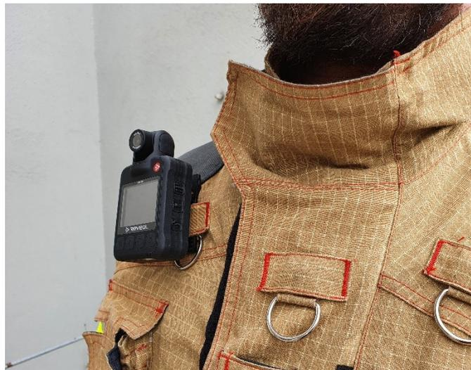
Abbildung 19: Reveil D5 befestigt mit Klemme an einer Textilschlaufe im Schulterbereich
