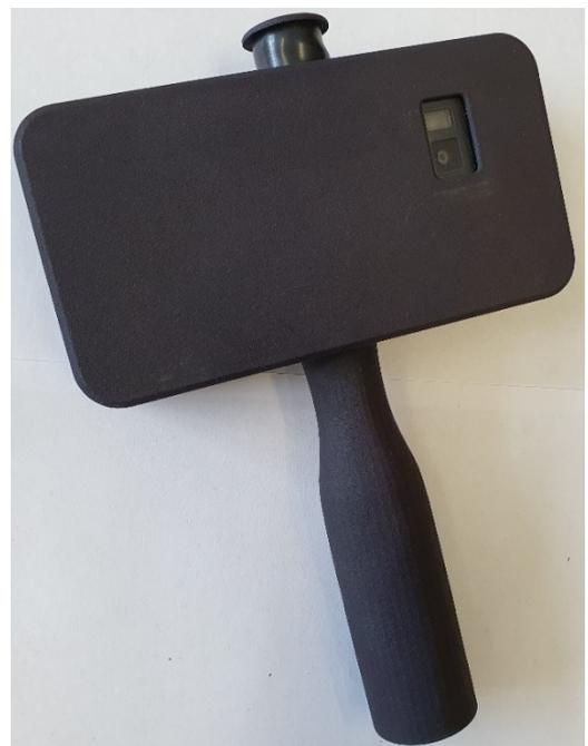
Abbildung 6: BOS Cam Ex 1 im Schutzgehäuse
