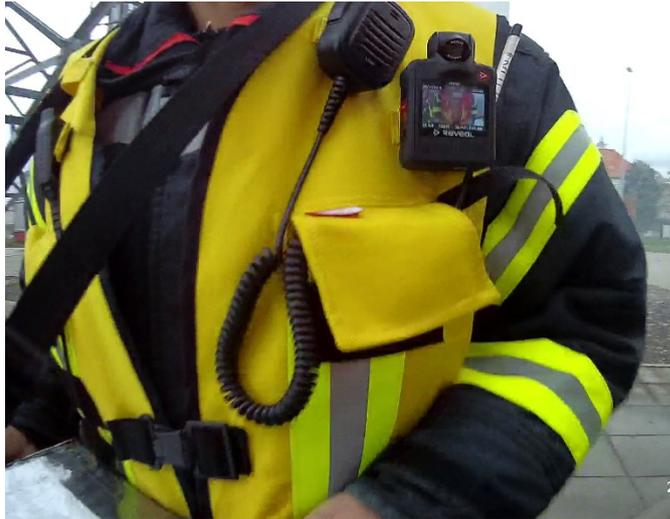
Abbildung 18: Reveil D5 an der Funktionsweste eines Einsatzleiters
