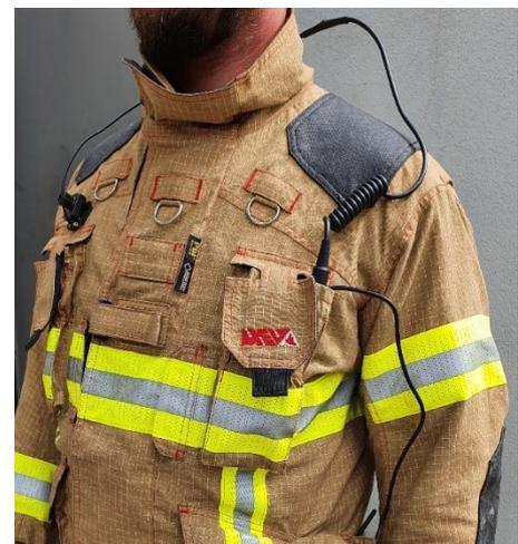
Abbildung 22: Zepcam T1 live mit Kompaktkamera befestigt an der Einsatzjacke
