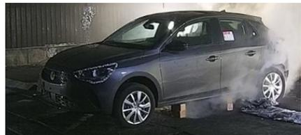
Abbildung 3: Beispiele für die Phase des Ausgasens des Batteriesystems
