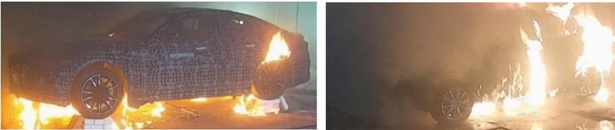
Abbildung 4: Beispiele für die Brandentwicklungsphase
