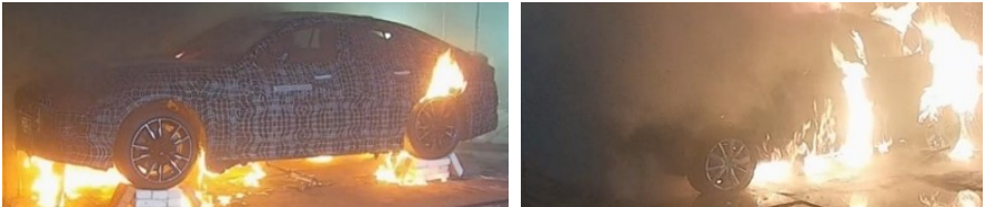
Abbildung 4: Beispiele für die Brandentwicklungsphase
