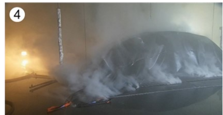
Abbildung 7: Einsatz der Brandbegrenzungsdecke an einem Elektrofahrzeug mit Batteriebrand
