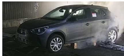
Abbildung 3: Beispiele für die Phase des Ausgasens des HV-Speichers 4
