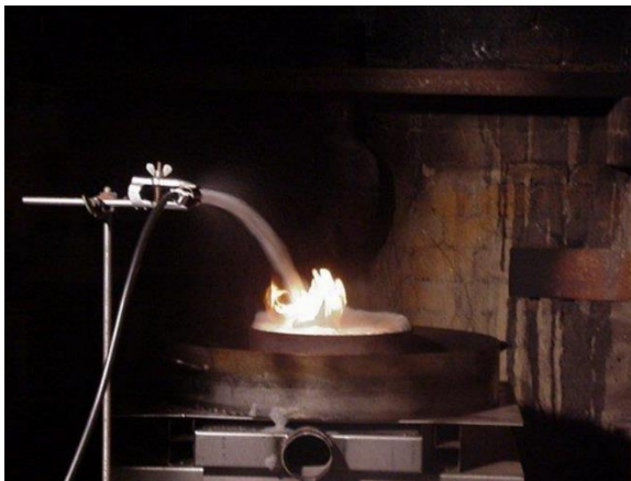
Abbildung 2: Löschen des Poolbrandes durch direkte Schaumaufgabe
