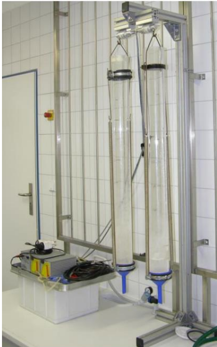
Abbildung 1: Versuchsaufbau zur Bestimmung der Wasserhalbwertzeit
