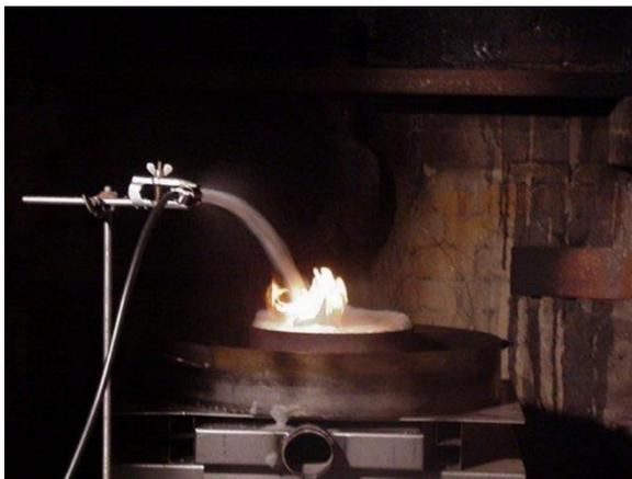
**Abbildung 2:** Löschen des Poolbrandes durch direkte Schaumaufgabe
