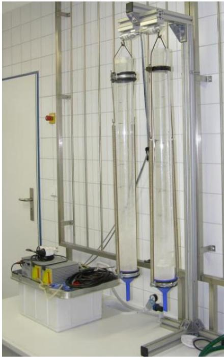
Der Versuch ist beendet, wenn aus dem Schaum kein Wasser mehr austritt. Für das Versuchsprotokoll ist eine Grafik zu erzeugen, die den zeitlichen Verlauf der Schaummassen aufzeigt. Aus den Messwerten ist die Wasserhalbwertzeit als die Zeit zu ermitteln, bei welcher der Masseverlust 50 % der Ausgangsmasse beträgt.
