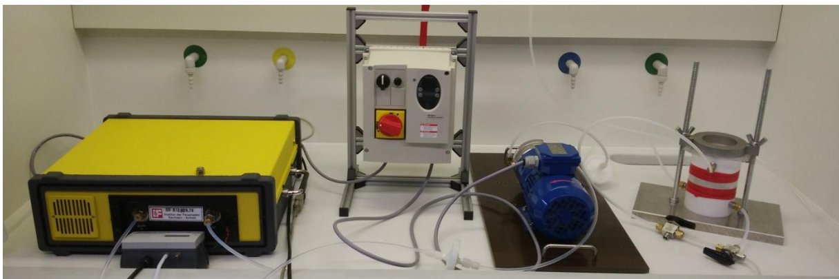
Abb. 1 Versuchsaapparaturen von links nach rechts: FTIR, davor: Differenzdruckmesser, Umrichter der Gaspumpe, Gaspumpe, 2-Kammer-Versuchsstand
