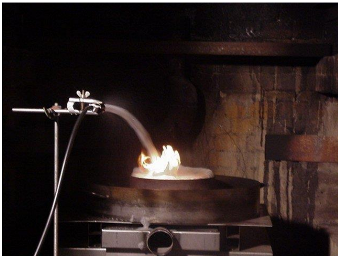
Abbildung 2: Löschen des Poolbrandes durch direkte Schaumaufgabe
